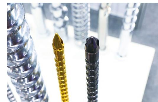
プラスチック成形では硬質フィラーによるアブレシブ摩耗だけでなくガスによる腐食など種々の課題があります。
