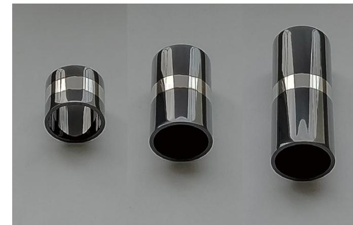
サンプル長軸方向への DLC 被膜つきまわり性の差異が顕著に確認されます。開口径に対して穴長さが 1 倍のものにおいては約 40% の、3 倍のものにおいては約 85% の中心部での膜厚減少がそれぞれ確認されます。
