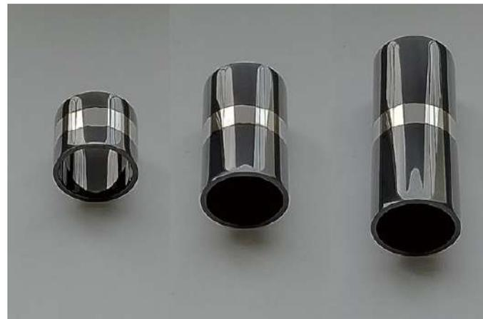
サンプル長軸方向への DLC 被膜つきまわり性の差異が顕著に確認されます。開口径に対して穴長さが 1 倍のものにおいては約 40% の、3 倍のものにおいては約 85% の中心部での膜厚減少がそれぞれ確認されます。形状もののコーティング膜厚評価の蓄積によって、より高精度な成膜技術を、複雑な形状を有する製品へフィードバックするため、日々技術力の向上を行っています。
