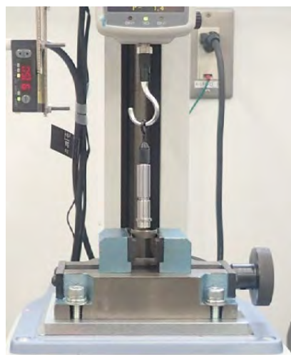
引張試験機にボールホルダー / 試料をセット
