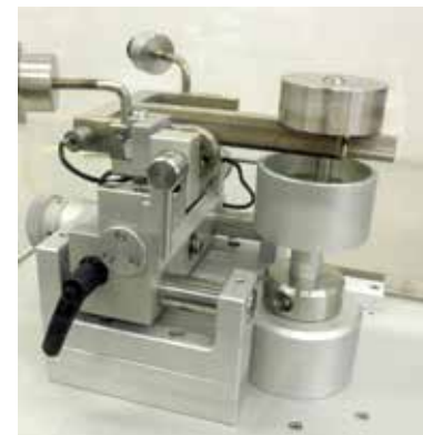
油中回転ボールオンディスク試験
