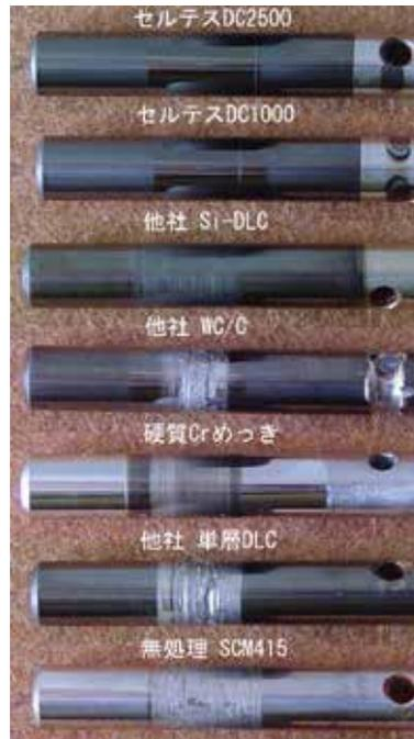
ファビリ試験による各種硬質薄膜のドライ環境での耐焼付き性評価
