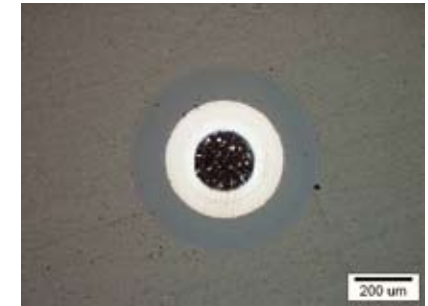
SKH51+下地層 0.6 μm/DLC 層 2.2 μm (エッチング)
