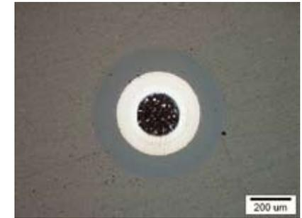
SKH51+下地層 0.6 μm/DLC 層 2.2 μm (エッチング)
