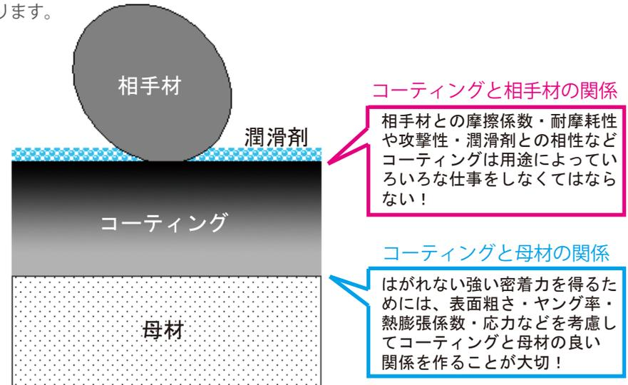
■ ここでは金型・摺動部品や切削工具に使われるハードコーティング=硬質薄膜に絞ってご説明します。硬質薄膜ですから当然ほかの材料より硬いことが特徴です。硬いと言えまづ頭に浮かぶのが「ダイヤモンド」ですね？次に来るのが「セラミック」でしょうか。
