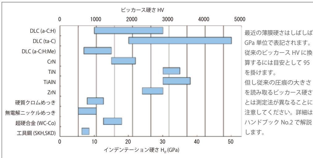
■ 同じ成分のセラミックでも、セラミック粉末を焼き固めて（焼結）作ったバルク材料と、真空中でプラズマを利用して作る薄膜材料では結晶構造も違いますし機械的特性も違います。また薄膜では作る時の成膜条件（たとえば製品の温度や窒素ガスの圧力、イオンのエネルギーなど）によって特性はいろいろ変化します。CrN（窒化クロム）と表記してある薄膜でも作り方によって随分特性（性能）が違うことがあることに注意してください。
