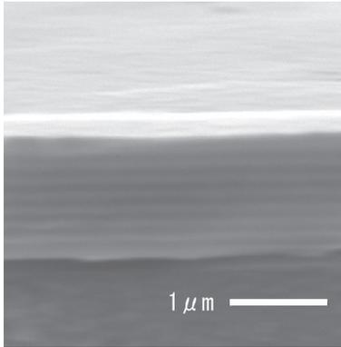
16層多層膜の破断面 SEM 写真
