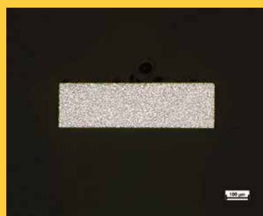
コネクタ成形金型 (セルテス X) ピン断面 0.8 x 0.2 mm
