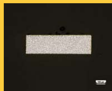
コネクター成形金型（セルテスX） ピン断面 0.8 x 0.2 mm
