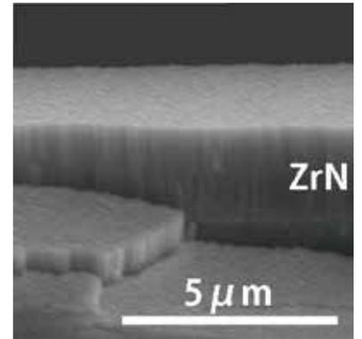
ZrN 破断面（多結晶構造）
