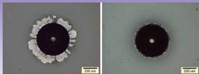
単層 DLC 2.6μm セルテス DC2500 2.5μm
