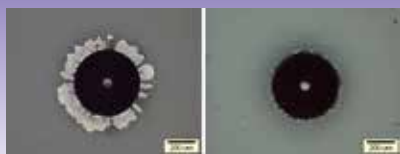
単層 DLC 2.6μm セルテス DC2500 2.5μm ロックウェル圧痕による密着力試験 (母材 SUJ2)
