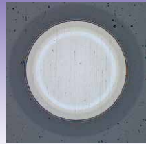
セルテス DCY 3μm カロテスト研磨痕
