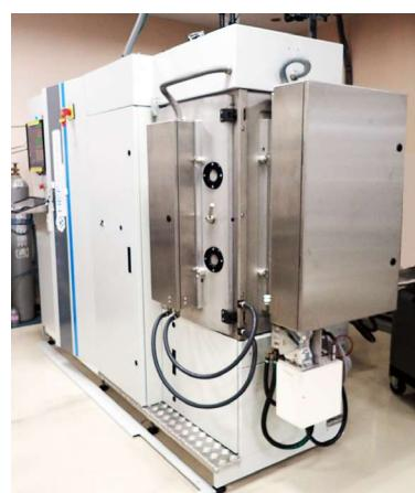
図1 ナノコート・ティーエス石川事業所に設置した中型成膜装置「TSD 550」
